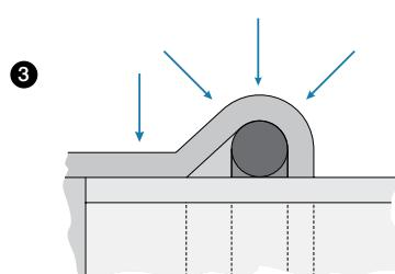
Spajanje elemenata u tehnologiji „Press“ omogućuje dobivanje spojeva s minimalnim sužavanjem proreza cijevi, što značajno smanjuje gubitke tlaka u cijeloj instalaciji i stvara savršene hidrauličke uvjete.
