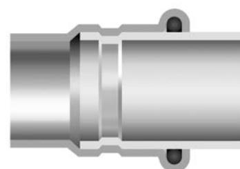
3. Spoj s četiri točke u Sustavu KAN-therm Steel.
