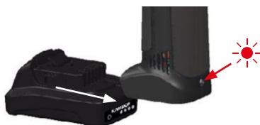
2x kurzes Blinken nach Akkueinbau - Selbsttest
