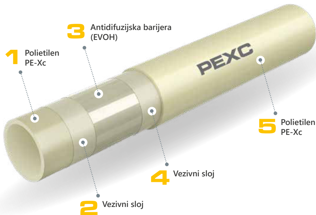
Poprečni presjek PEXC cijevi s EVOH slojem
