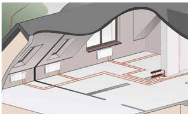
Razdjelnik - T sistem u instalaciji grijanja
