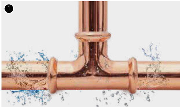
1. Signaliziranje neprešanih spojeva LBP 2. LBP funkcija izvodi se ovalizacijom tijela spojnice
