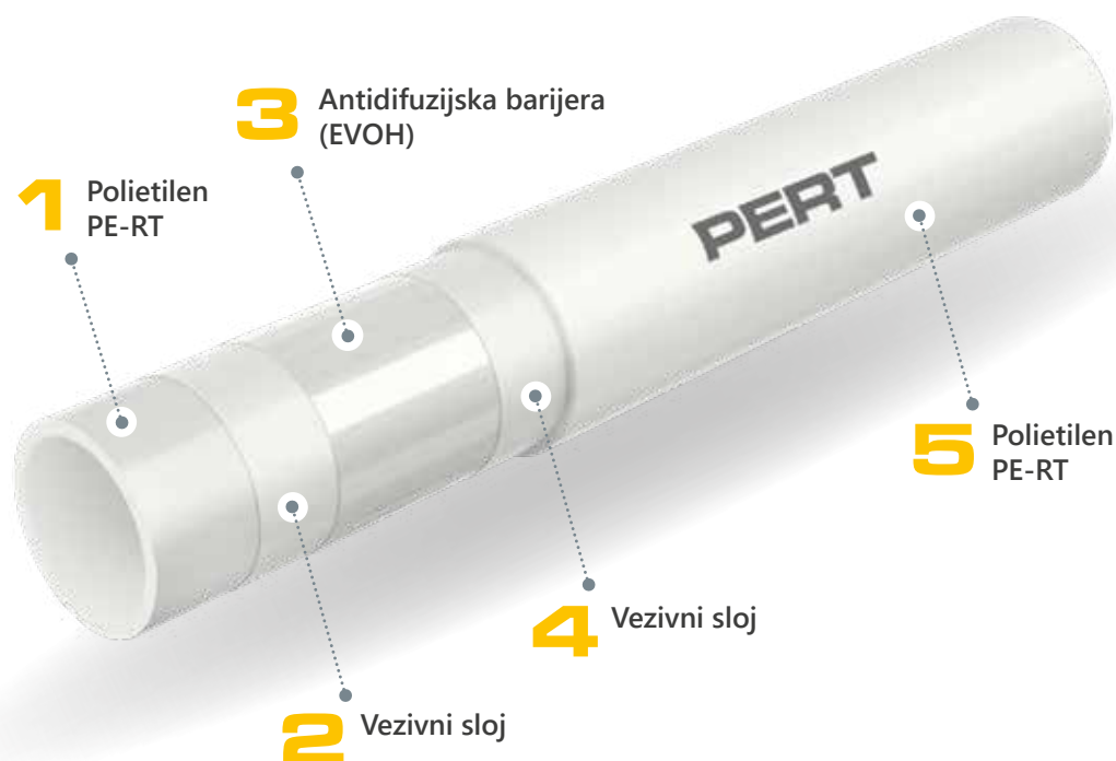
Poprečni presjek PERT cijevi s EVOH slojem
